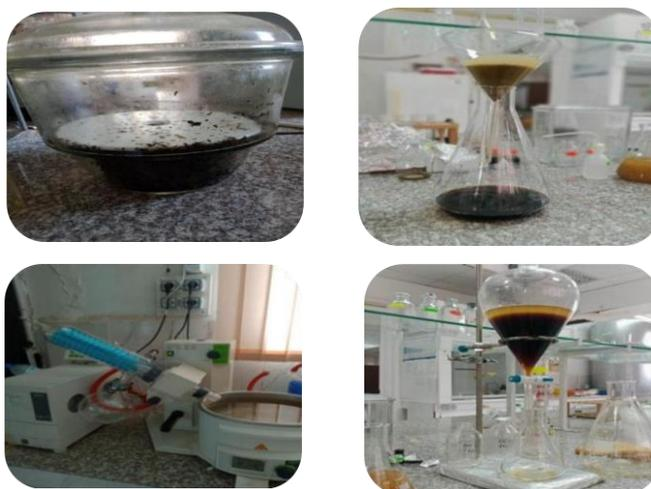
**Figure 11 :** Les différentes étapes de macération, de filtration, d'évaporation et de l'extraction liquide-liquide de l'extrait hydralcoolique d'une plante de la famille des Rosacées.
